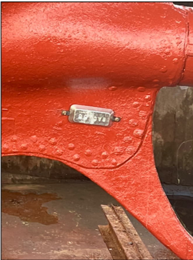
Vi er nød til at vende skibet på hovedet -Tæreklodsen sidder omvendt
