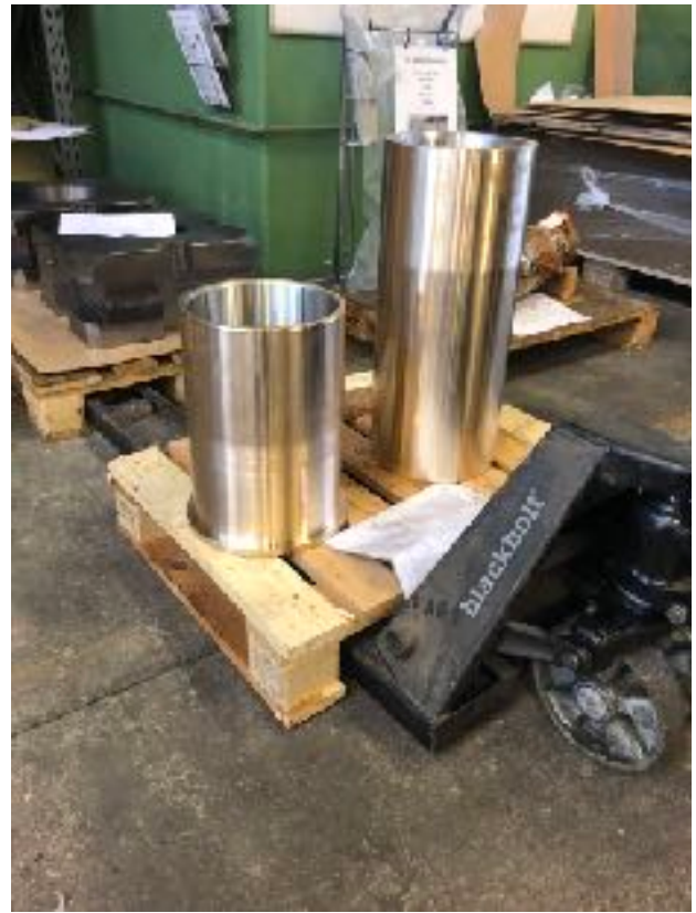
Og her er de så: Bjørns nye skrueaksellejer, dagen efter de var støbt.
